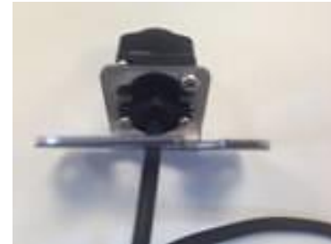
In Montagebügel um 180° gedrehte Kamera
